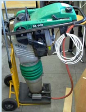
Abb. 1: Wacker BS 600 Vibrations-Stampfer mit angeschlossener Sensorbox.
